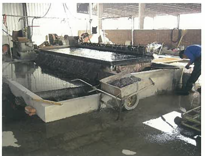
電線水洗浄、分別
